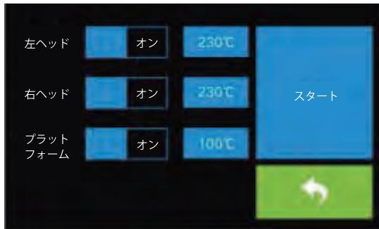
予熱ボタンをクリックして、左側に設定された温度まで予熱する。デフォルトは 230°、温度値をクリックして温度設定が可能です。
