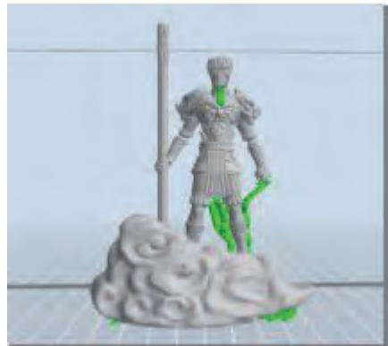
正しいサポート方式：枝形の使用することによって時間の節約と
