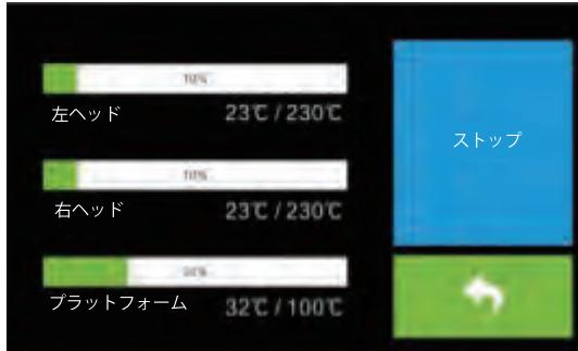
ヘッドの加熱される画面に入り、目標温度値と現在の温度値が表示される。取消をクリックすると予熱作業が取消される
