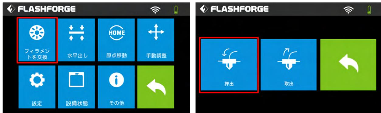
6.3.6 ノズルが設定温度に達するとビープ音が鳴り、フィラメントをヘッド内のエクストルーダーにロードするよう求められます。
