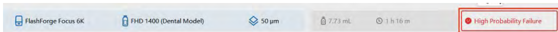
図50 印刷に失敗する可能性がある場合に表示されるインターフェース図
