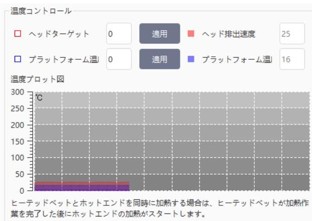
注: ヘッドとプラットフォームを両方加熱する場合、プラットフォーム加熱完了後、ヘッドを加熱します。
