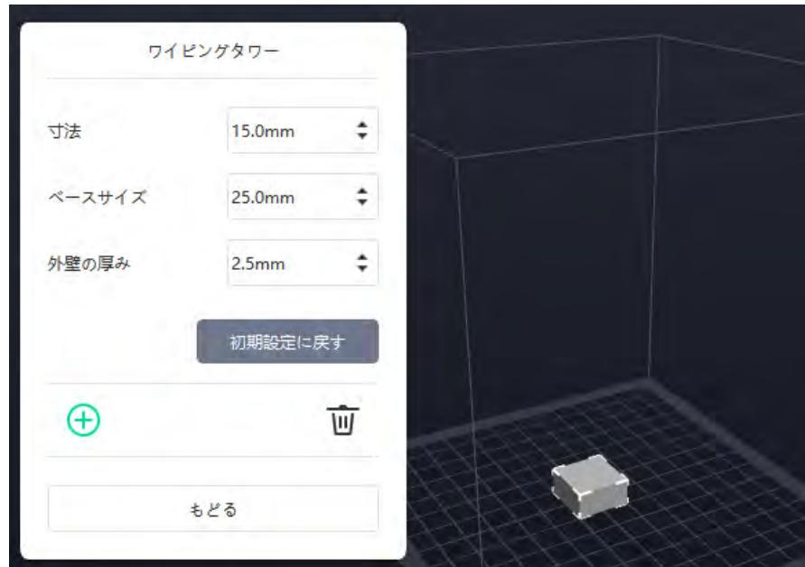
シングルノズルのプリンターの場合、ワイピングタワーオプションで寸法、ベースサイズ、外壁の厚みを設定します。ワイピングタワーは、印刷するモデルと同じ高さになるように設定します。複数のモデルがある場合は、最も高いモデルの高さに合わせます。
