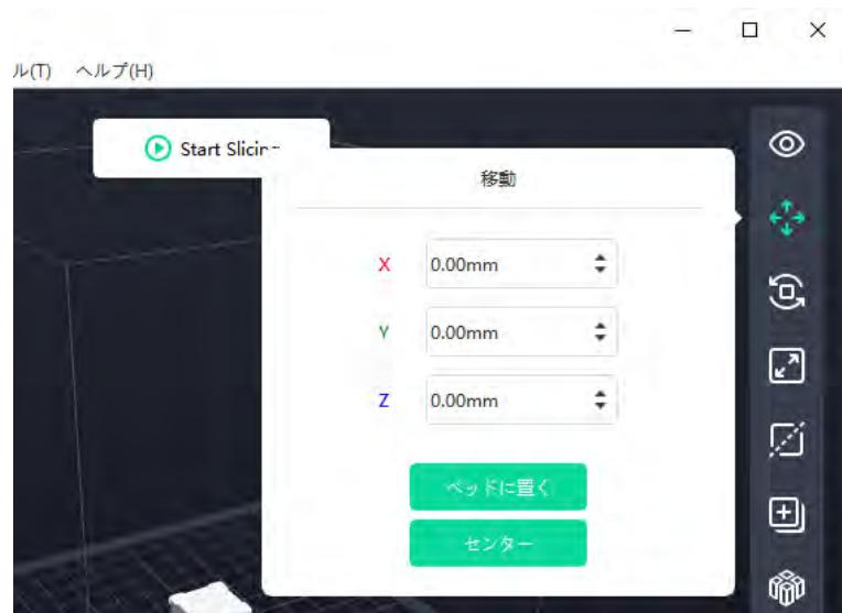
※一般的にはモデルの位置を調節した後、[移動]アイコン内の[センター]と[ベッドに置く]を選択して、モデルがプリント範囲内に位置していることと、プラットフォーム上に設置されていることを確認する必要があります。配置に指定のあるモデルであれば、[ベッドに置く]だけ選択します。
