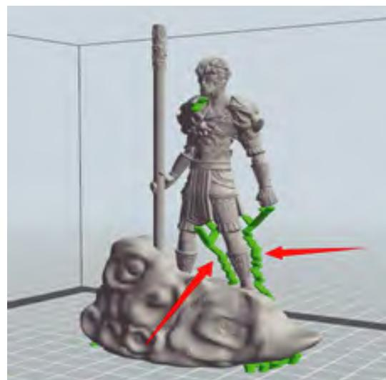
20、【追加する】アイコンをクリックしてマウスを追加したい場所に移動して左ドラックすると枝形のサポート材が追加されます。
