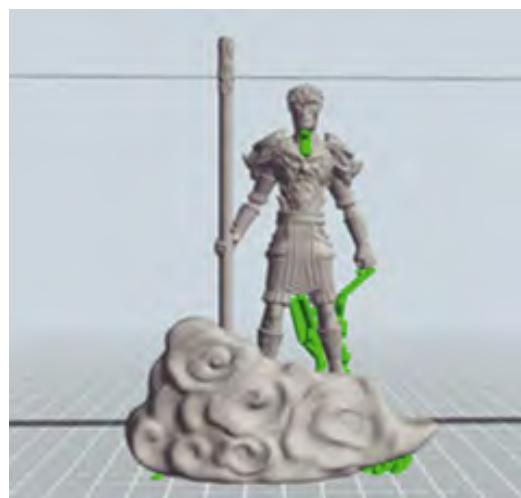
6、間違ったサポート方式：ライン形を使用すると多くのプリント材料が無駄になりプリント時間も長くなります。そしてサポート材を剥がす手間もかかります。
