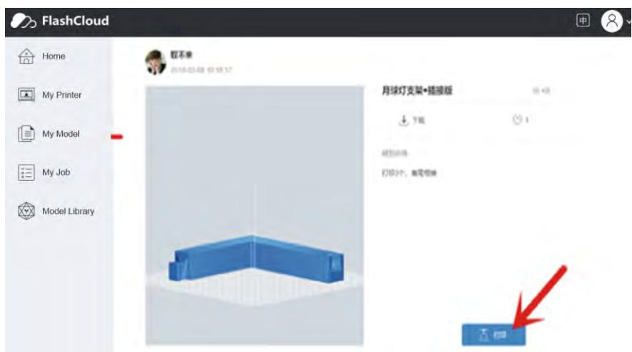
7) プリントジョブを実行するプリンタを選択し、[ プリント ] をクリックします。最後に、[ スタート ] をクリックすると、選択されたプリンタが操作を自動的に開始します。プロセス全体でのプリントに必要な残り時間、ヘッドの温度、プラットフォームの温度などはすべて表示され、クラウドでプリントジョブはいつでも一時停止またはプリントのキャンセルができます。
