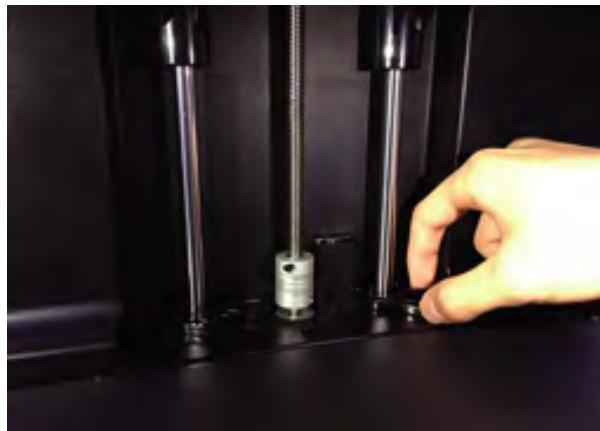
(図 3-6) Z 軸底部のロック部品を外します。
