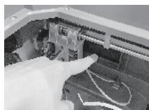
10. X軸とY軸のタイミングベルトのクリップを外します。
