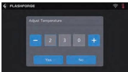
左右の押出器とビルト板の温度の変更方法
