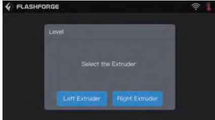
2. 押出器とビルト板の動きが止まつたら、左右の押出器でどちらの水平を出すか選択します。
