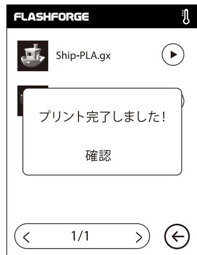
3. エクストルーダー(押出口)が自動的に加熱され、加熱が完了するとプリンターはモデルをプリント開始します。印刷が完了するとビーブ音が鳴り、タッチスクリーンに通知が表示されます。
