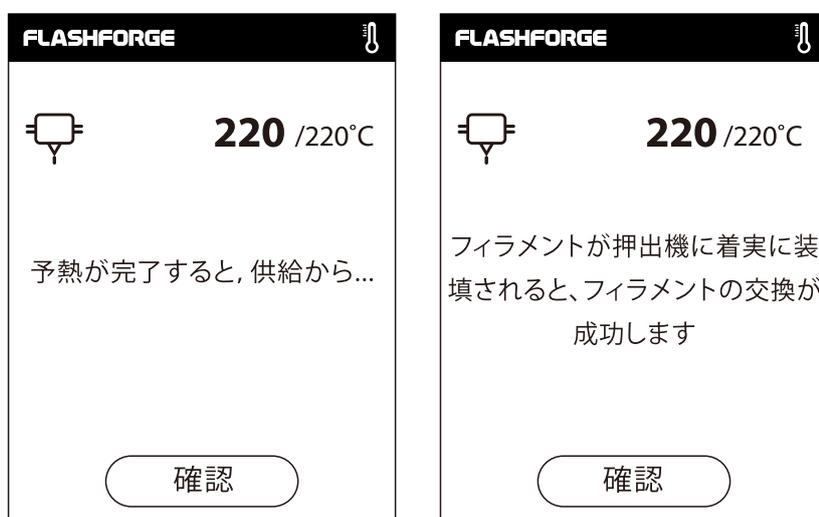
3. フィラメントがエクストルーダーから出てきたら押し出しは完了です。[確認を]タップします。フィラメントをフィラメントカートリッジに載せ、フィラメントカバーを閉じます。
