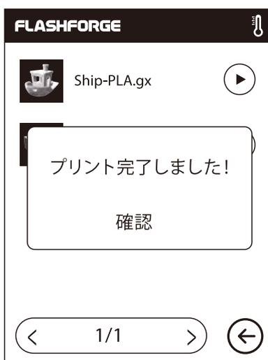
3.エクストルーダー(押出機)が自動的に加熱され、加熱が完了するとプリンターはモデルをプリント開始します。印刷が完了するとビーブ音が鳴り、タッチスクリーンに通知が表示されます。
