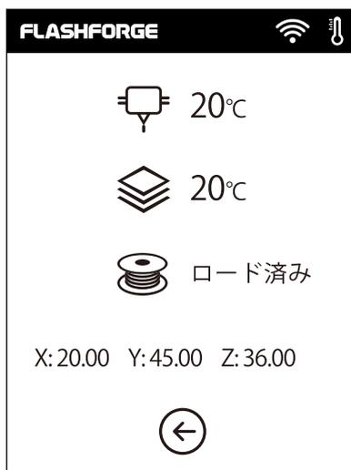
状態: X軸、Y軸、Z軸のリアルタイム座標、およびヘッドとプラットフォームのリアルタイム温度が表示されます。
