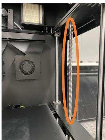
3. 庫内左右にあるボールネジのネジ軸を時計回りに回し、プラットフォームフォームプレートが緩衝材を外せる位置まで上昇した後、ネジ軸の片方を固定しつつ緩衝材を引き抜く。
