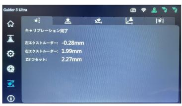
(2)完了後、自動的に校正データは保存されます。 数値に異常がある場合には再確認を促す メッセージが表示されますので、 ノズルセットの緩みなどを確認し、再校正を 行ってください。
