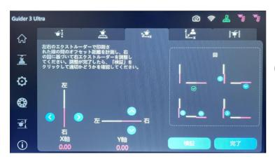
(2)出力が完了したら、定規を使って2本の線の同じ 方向のずれ距離を測定します。 出力されたテストラインと画面上の例を比較し、 左ノズルを基準に右ノズルのXYオフセットを 調整します。
