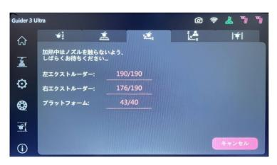
※デフォルトではPLAの設定で出力します。 別素材での場合には加熱中に任意の温度に 変更してください。
