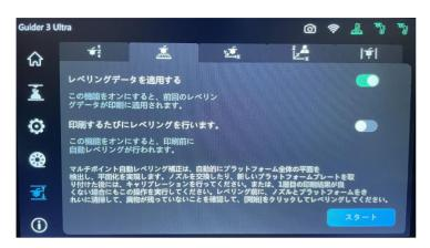
(1)各印刷で同じレベリングデータを使用するか、 各印刷の前に自動レベリングを実行するかを 選択できます。
