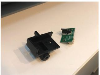
2-3 センサーを交換し、逆の手順で組みなおします。 電源を入れ、正常な動作が確認できれば作業は終了です。
