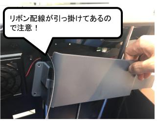
赤丸で示した部分のネジを外しますと金属プレートが取り外せます。 1-2 リボン配線が本体に両面テープで固定されておりますので、引っ張って慎重に取り外します。
