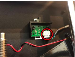
2-2 赤丸で示した部分のネジを取り、センサーを取り外します。
