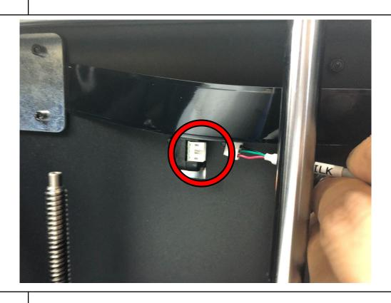
3-2 赤丸で示した部分のネジを取り、センサーを取り外します。 ななめに向けると取りやすいです。
