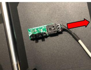
4-2 赤丸で示した部分のネジを外し、センサーを取り外します。
