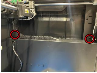
1-2 プリンタ内部にある赤丸部のネジを取り外します。
