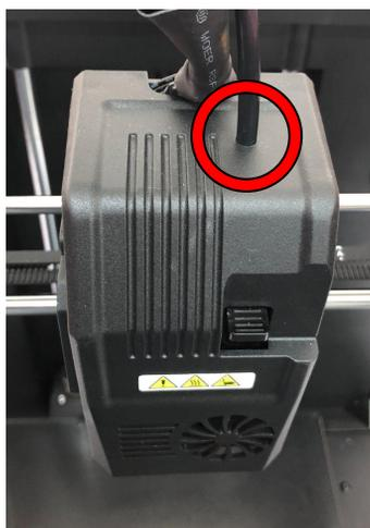
1-2 ヘッド後ろ側の六角ネジ2本を外し、ヘッドカバーを外します。
