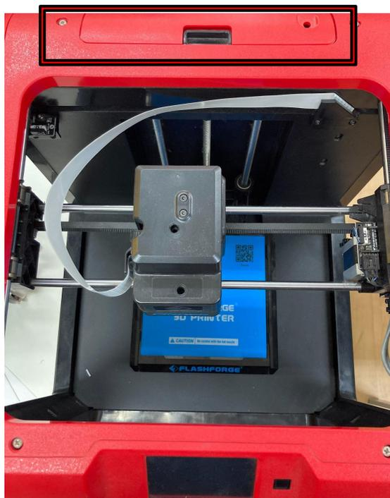
1-2 背面の4つのネジを外して金属板を外します。
