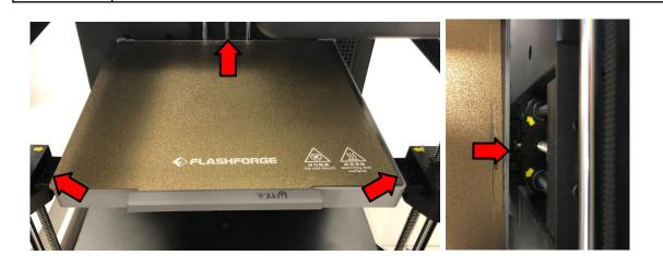
プラットフォームを外し、裏向けると配線カバーにアクセスできます。 1-2 でっぱり部分を赤矢印の方向へ押すことで簡単に開きます。 開いたら押し込み式の配線をそのまま矢印方向に引っ張って外します。
