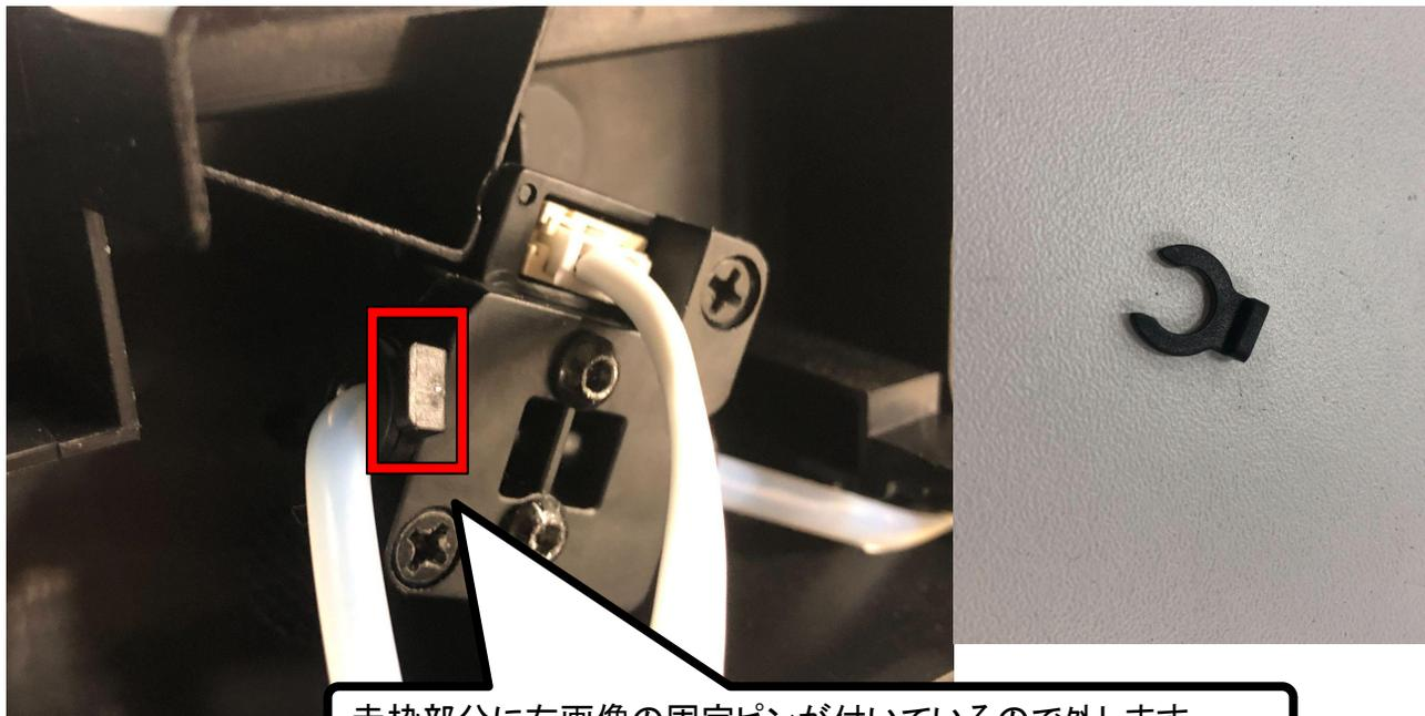
赤枠部分に右画像の固定ピンが付いているので外します。
