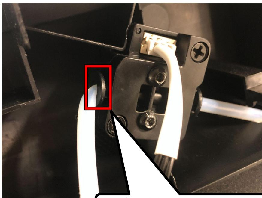
ピンが外せたら黒いパーツ部を押しながらガイドチューブを引っ張り抜きます。
