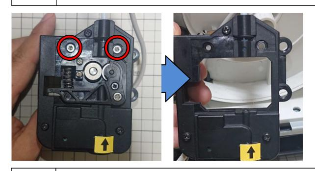
3-4 センサーカバーを外すとモーターとエクストルーダーのみとなります。 プーリー側を止めている六角ねじを緩め、部品を外してください。 ※取り付けの際は、しっかりと締めてから1回転半緩めてください。
