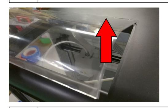
本体上部の蓋(透明部分以外)を外します。透明蓋を外すと、 1-4 黒色の蓋のみが残ります。ここもツメで引っかかっているだけですので、 上に持ち上げて外してください。
