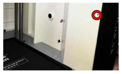
本体内部右側面のネジを 1 本外します。 本体内部の右側面に、1つプラスネジがあります。ここを外してください。
