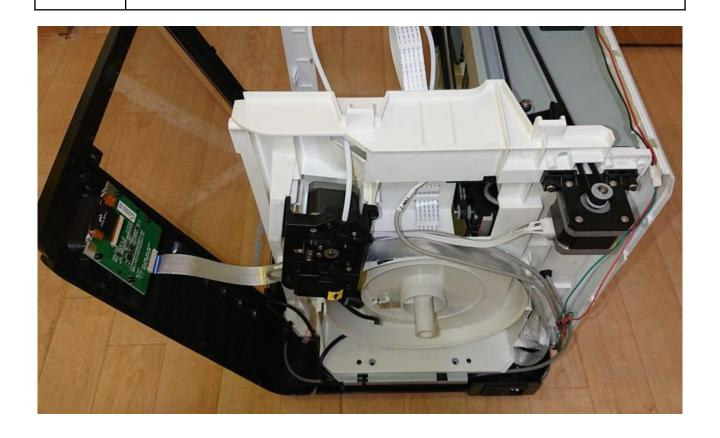
この後の作業の為に前面のカバーを完全に外します。 タッチパネルから配線を抜き、USB配線をネジ2本外して取り外します。
