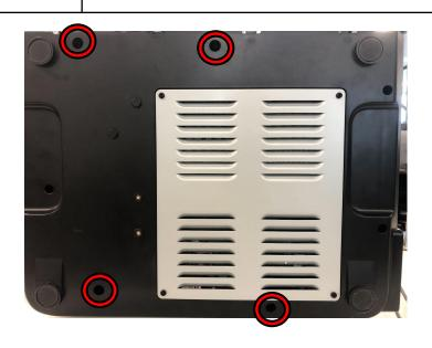
下記画像の4本のネジを外すと底面が外せるようになります。 1-14 底面カバーは完全には外せず、配線が付いているので断線に注意してください。
