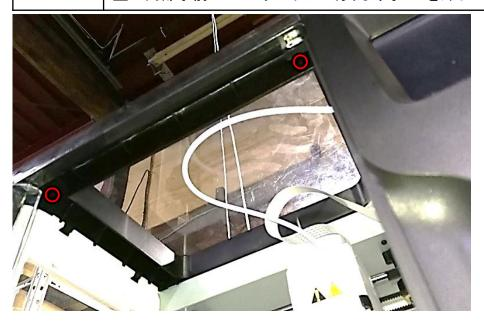
1-2 本体内部右側面のネジを1本外します。 本体内部の右側面に、1つプラスネジがあります。ここを外してください。
