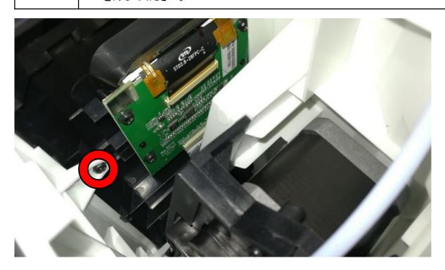
本体上部の蓋(透明部分以外)を外します。透明蓋を外すと、 1-6 黒色の蓋のみが残ります。ここもツメで引っかかっているだけですので、 上に持ち上げて外してください。
