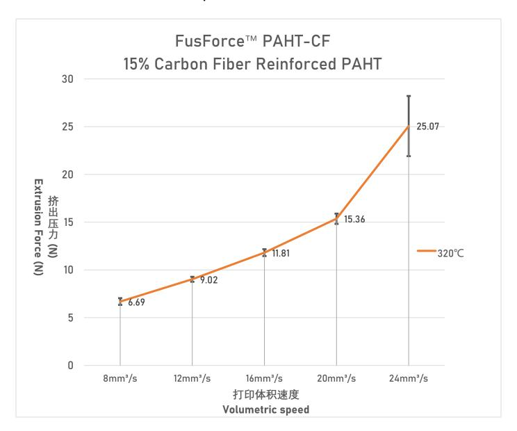
测试参数: 20mm 长度铜制加热块,BMG 挤出机,Phaetus 硬化钢喷头,喷嘴大小 0.4mm,层高 0.2mm。
