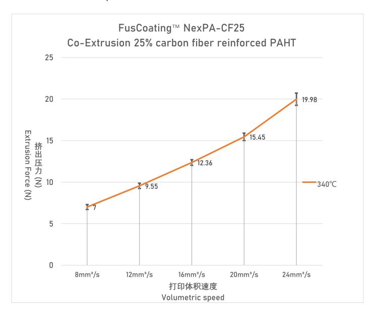
测试参数: 12mm 长度铜制加热块,BMG 挤出机,Phaetus 硬化钢喷头,喷嘴大小 0.4mm,层高 0.2mm。 Test parameters: 12mm length brass heat block, BMG extruder, Phaetus Hardened Steel Nozzle, Nozzle size 0.4mm, Layer Height 0.2mm.
