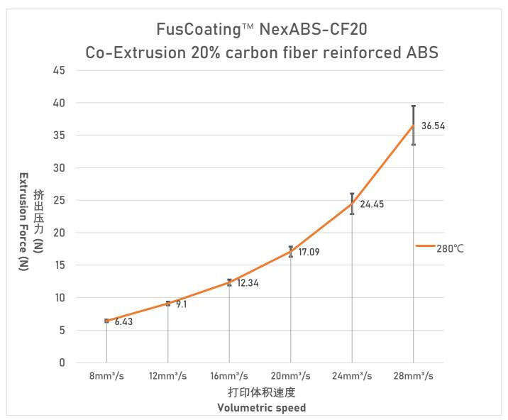
测试参数: 12mm 长度铜制加热块,BMG 挤出机,Phaetus 硬化钢喷头,喷嘴大小 0.4mm,层高 0.2mm。
